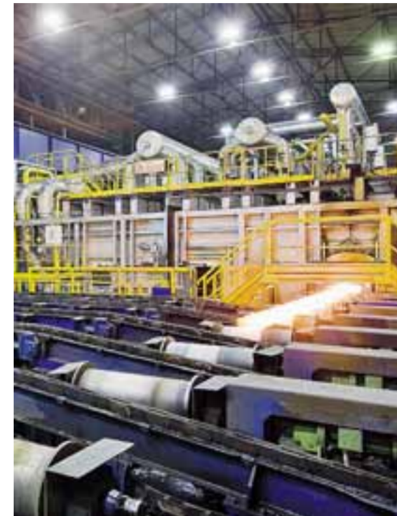
In alto, Michele e Margherita Bendotti. A sinistra, particolare dell'impianto «walking beam per bramme» di Verona Steel. Sotto, l'ingresso dello stabilimento di Costa Volpino (foto Tarzia)
